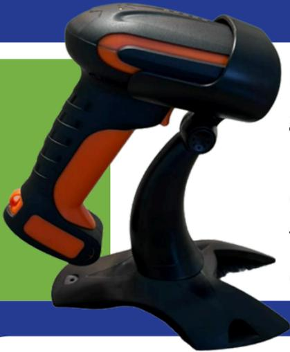
El lector inalámbrico ADVANCED LI-116WI tiene dos modos para gestionar datos. El modo instantáneo transfiere los códigos de barras directamente al documento que estás usando. Por otro lado, el modo de almacenamiento es ideal para cuando el lector está fuera del alcance inalámbrico, ya que guarda hasta 100,000 códigos en su memoria para que puedas subirlos más tarde.
