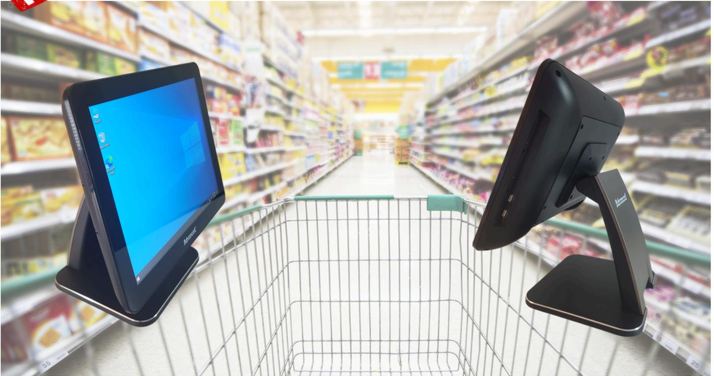
En entornos de alto tráfico y gran impacto, es crucial disponer de hardware POS resistente. El modelo APT-6412 cuenta con una robusta y elegante carcasa de aluminio fundido a presión, diseñada para protegerlo de polvo, suciedad y derrames. Gracias a su diseño sin ventilador, se reduce el riesgo de daños en los componentes internos.
