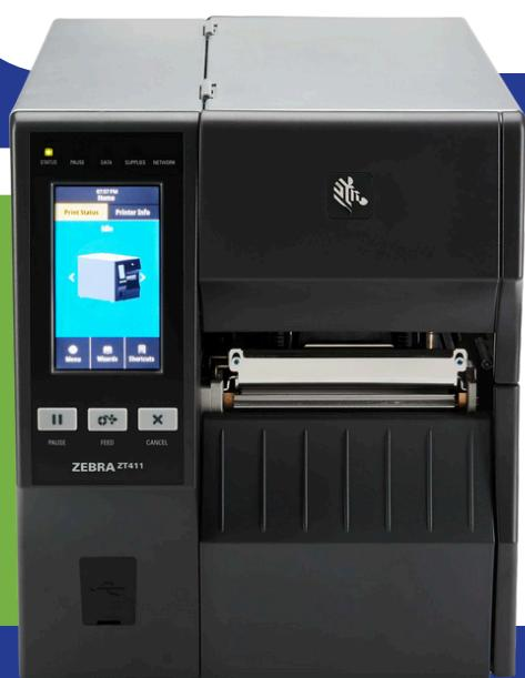
La ZT411 es capaz de imprimir en una variedad de materiales y grosores, desde etiquetas continuas hasta troqueladas y perforadas. Su ancho de impresión de 4,09 pulgadas (104 mm) y su memoria de 256 MB de SDRAM y 512 MB de memoria flash la preparan para manejar formatos complejos. Además, soporta múltiples lenguajes de programación como ZPL y EPL.
